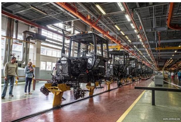
На базе выпускаемых тракторов «BELARUS» и с использованием их узлов и агрегатов завод организовал производство 15 моделей так называемой альтернативной техники: коммунальные, лесоразрабатывающие машины, транспорт для шахт, погрузочные машины.
