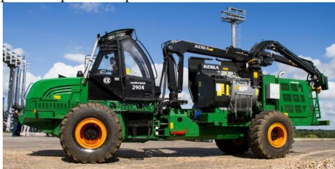
Машина рубильная АМКОДОР 2904 предназначена для рубки в щепу круглого леса, низкокачественной древесины, порубочных остатков, отходов лесопиления, дров и прочих лесоматериалов. Модель оснащена автономным рубильным модулем АМКОДОР 2831 с барабанной дробилкой.
