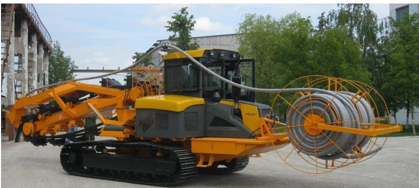
А вот мелиоративный экскаватор дреноукладчик ХТ17СД1, ноу-хау, которое готово соперничать с самыми популярными производителями в мире. За час эта эксклюзивная машина вместо 160 метров как раньше, проходит 2,5 километра. Но следует напомнить, для того чтобы разработать и выпустить
